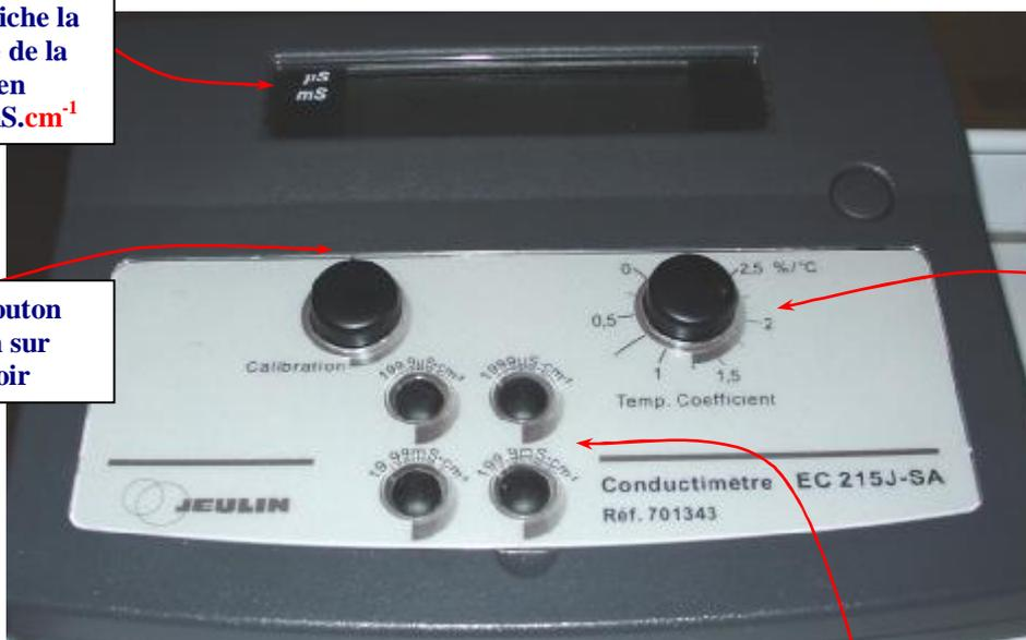
Régler le coefficient de température sur 2
