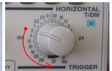
**Pour passer en mode XY, tourner le bouton T/DIV sur la position XY**
