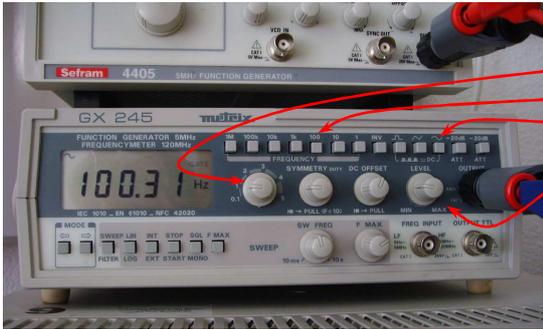
régler le signal modulant sur la voie 2 de l'oscilloscope :
