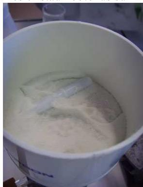
Les cristaux de paracétamol étant un peu soluble dans l'eau, il faut les rincer avec le minimum d'eau. Comme la solubilité du paracétamol dans l'eau diminue avec la température, il faut utiliser de l'eau distillée glacée pour limiter les pertes lors du rinçage.
