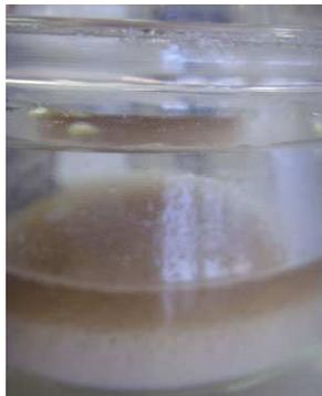
La solubilité du paracétamol diminue avec la température : en refroidissant le mélange réactionnel dans un bain d'eau glacée, la solubilité diminuant, la solution va devenir saturée en paracétamol et celui-ci va cristalliser.
