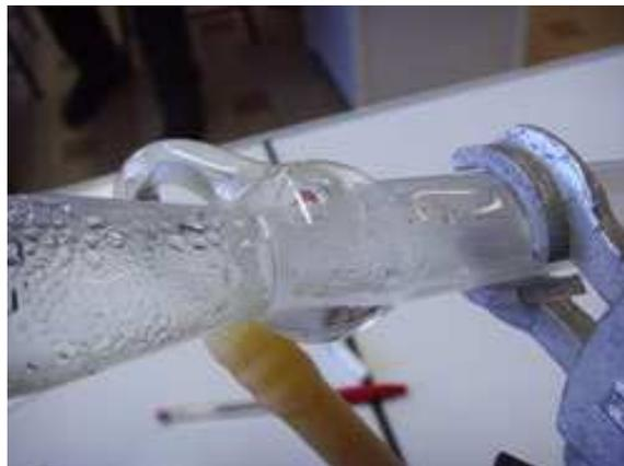
*condensation des vapeurs dans le réfrigérant*
