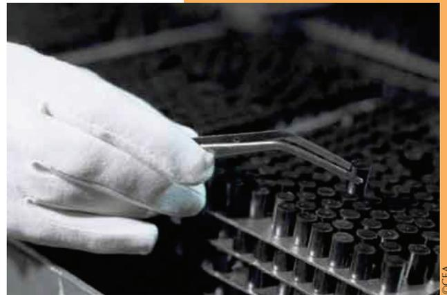
*Pastilles d'oxyde d'uranium. L'uranium enrichi, transformé en oxyde d'uranium, est compacté en pastilles cuites au four. Cylindre d'environ 8 mm de diamètre pesant de 7 à 8 grammes, une pastille produit à elle seule autant d'énergie qu'une tonne de charbon.*
