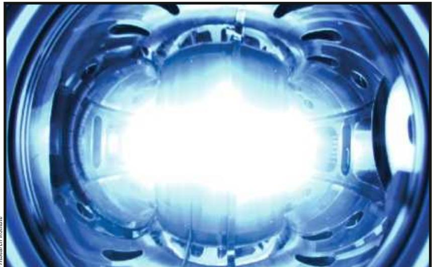
UNE VUE DU PLASMA à l'intérieur du tokamak sud-coréen KSTAR (Korea Superconducting Tokamak Advanced Research), installation de recherche qui a commencé à fonctionner en 2008.
