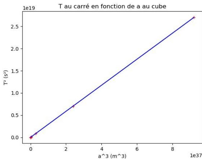
La 3<sup>ème</sup> loi de Kepler est vérifiée car la courbe est une droite passant par l'origine : il y a proportionnalité entre  $T^2$  et  $a^3$  :
