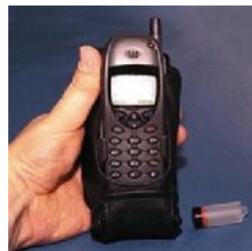
Téléphone portable à pile à combustible miniaturisée présenté en octobre 2000 par la société américaine Energy Related Devices ; à droite, le réservoir de méthanol amovible.
